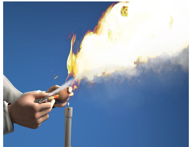
Abb. 14 Explosionsfähiges Staub-Luft Gemisch
