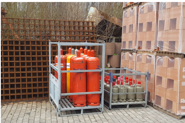
Abb. 27 Lagerung von Gasen incl. Transportgerät
